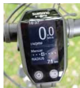
Schaltzentrale: Die Steps-Steuereinheit löst den Gangwechsel automatisch aus.
