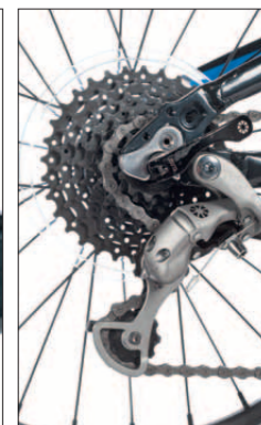
Das hauseigene Schaltwerk wechselt willig zwischen neun Ritzeln.
